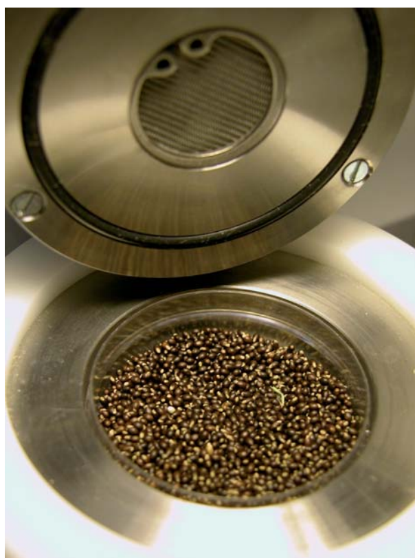
Primo piano di un misuratore dell'attività dell'acqua contenente semi di Viola dubyana Burnat. Questa strumentazione permette di misurare in maniera non distruttiva lo stato di idratazione delle accessioni di semi di una banca del germoplasma. Il valore di attività dell'acqua è correlato al contenuto in acqua. (Foto Costantino Bonomi)
