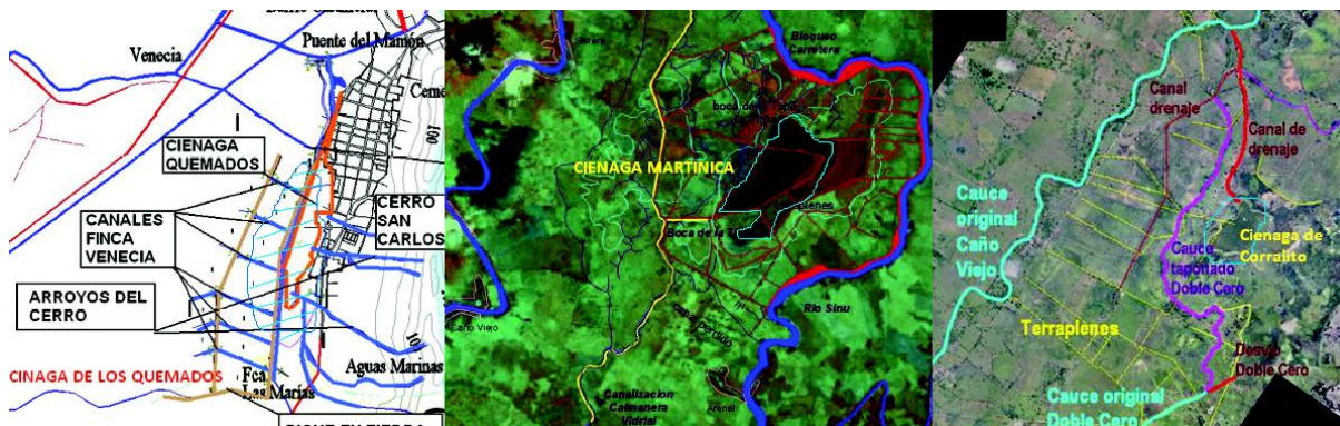
Figura 26: Planos de localización de tres ciénagas del curso medio del río Sinú (Córdoba), donde se observan las retículas de diques y terraplenes hechos para desecar los humedales con fines y propósitos de “ganar” tierra para la ganadería extensiva. Fuente: CVS-CI, 2009.
